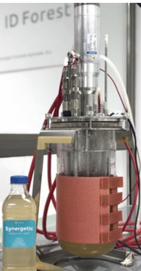
Biorreactor e inóculo bacteriano producido en él
